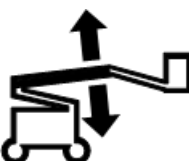
Subida/descida da lança primária
