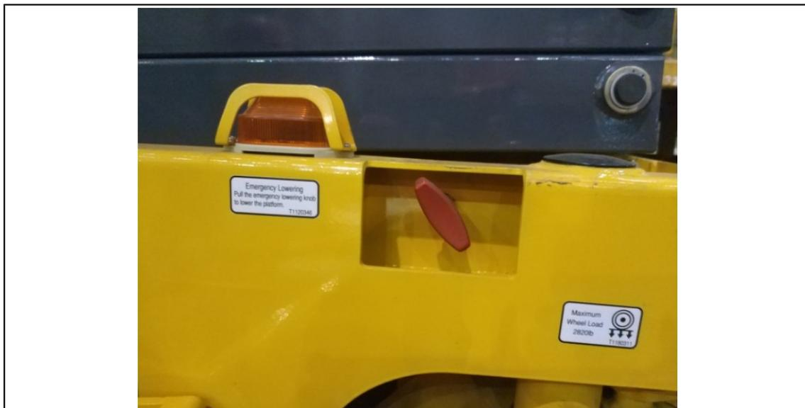
Figura 4-1 Posição de descida manual dos componentes de controle
